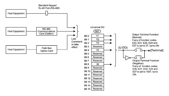
Figure 4.4 (d) Block Diagram of Universal DO
